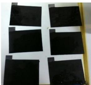
**Gambar 5.** Hasil fabrikasi elektroda karbon
